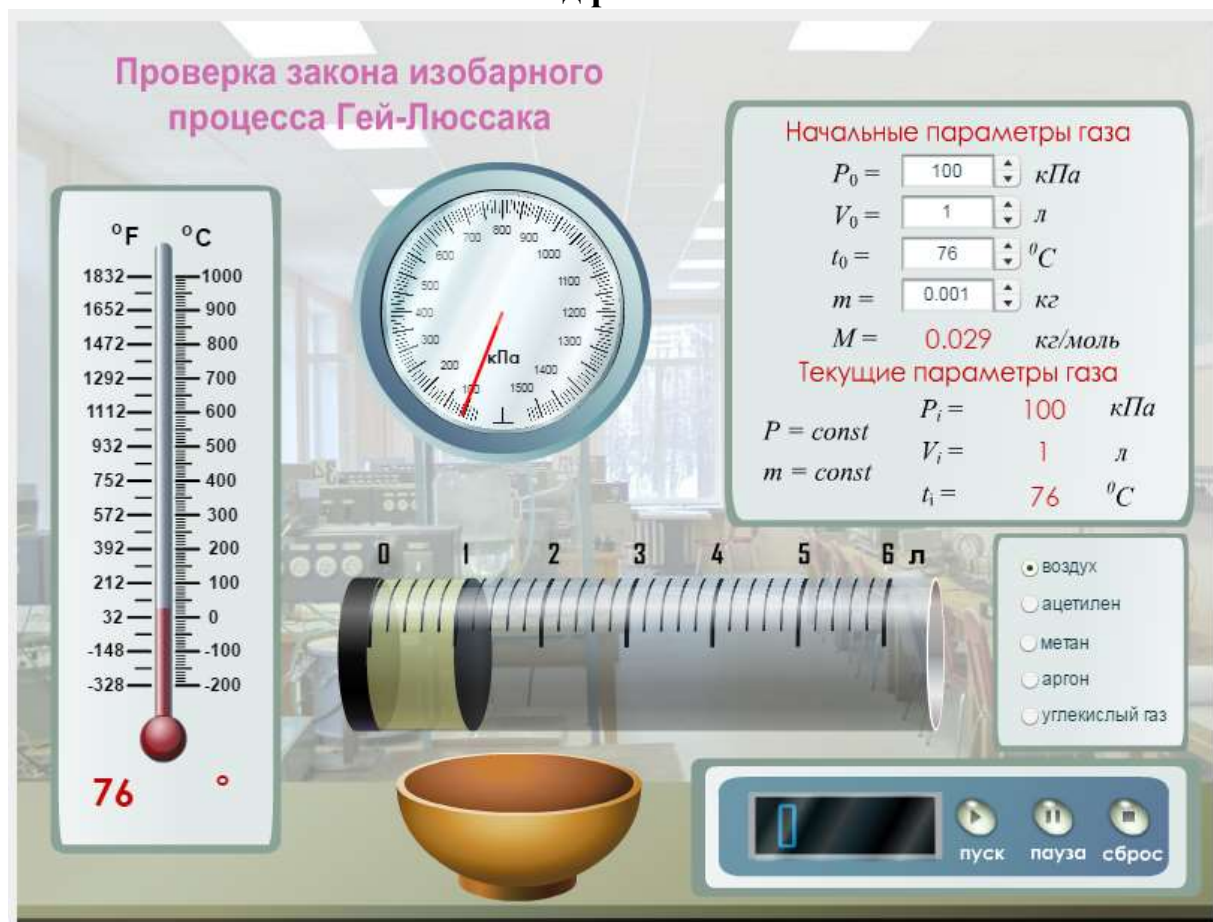
Рис. 2 – Модель экспериментальной установки для выполнения лабораторной работы
